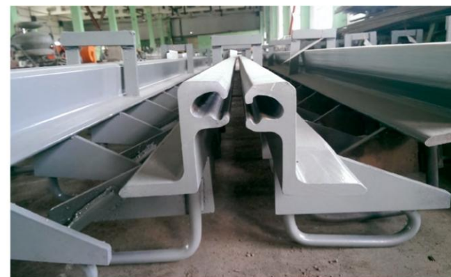
Конструкция деформационного шва СК-80
