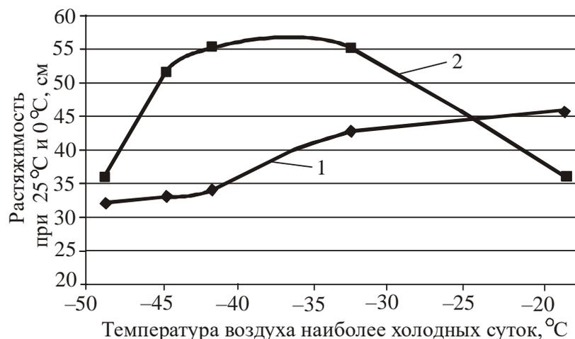
Рисунок Д. 3 – Зависимость растяжимости ПБВ при 25°C (1) и 0°C (2) от температуры воздуха наиболее холодных суток в районе эксплуатации покрытий
