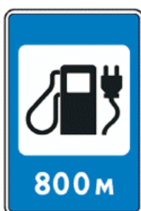
7.21 Автозаправочная станция с возможностью зарядки электромобилей
