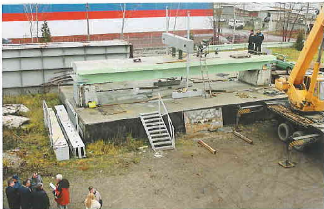
Фото 3. Натурный образец под статической нагрузкой 2х100 тонн
